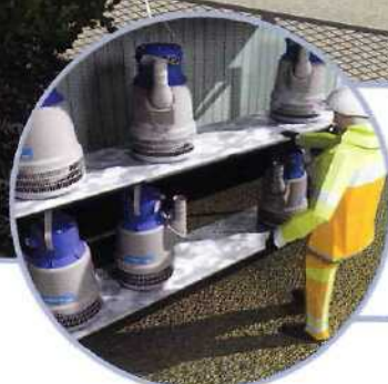
Резервные водоотливные насосы
