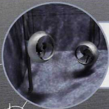
Перемешивание бурового раствора
