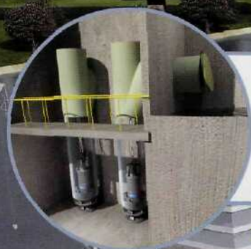
Главный водоотлив из дока
